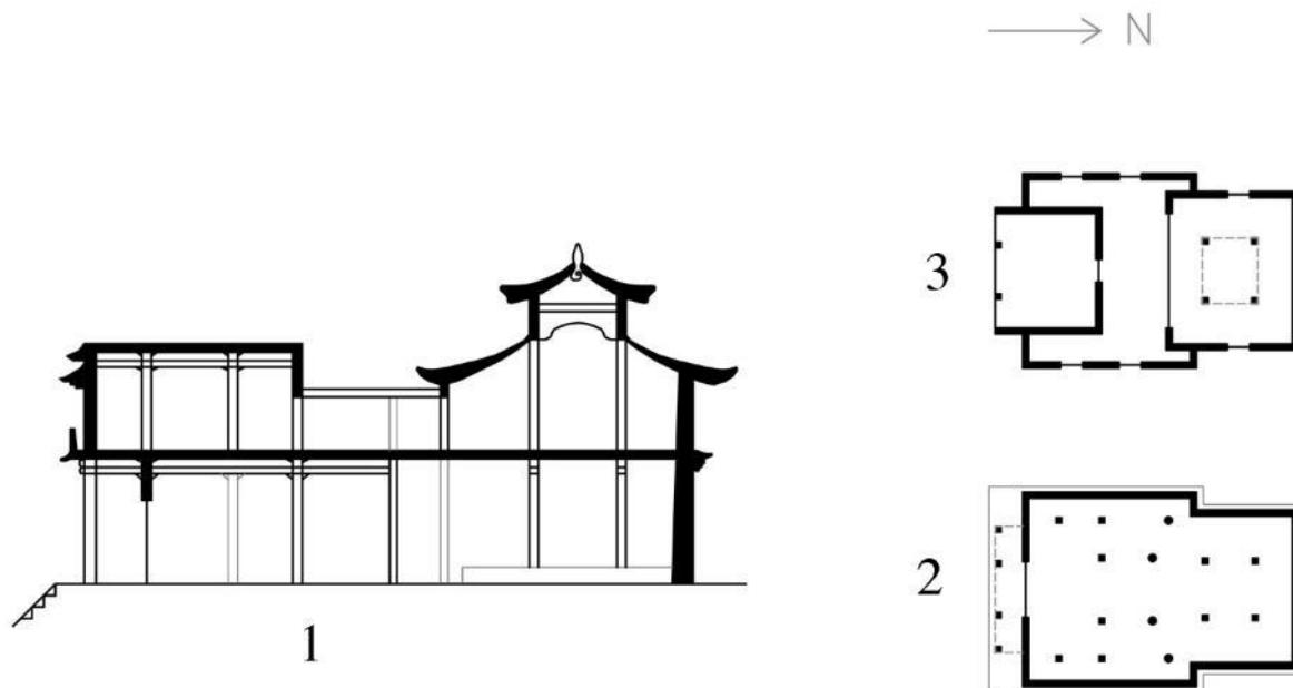
[13H]. 48. *Barayun üsütü süme (Üsütü juu, Tümed, état en 1995-1999)*. Plans et coupe transversale du youl coycin. © I. C. Outre qu'elle mêle piliers ronds et carrés, cette curieuse architecture mixte superpose charpente tibétaine au rez-de-chaussée et deuxième niveau à charpente chinoise.
