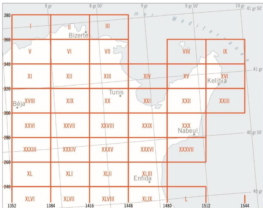
Figure 6. Découpage basé sur une grille plane. Le graticule des méridiens et des parallèles (coordonnées exprimées en grades en haut et à droite) est placé en biais par rapport à la grille de découpage des feuilles. Extrait du tableau d'assemblage de la carte de Tunisie, 1:50 000, édition française, 1881-1946. Dessin de l'auteur.
