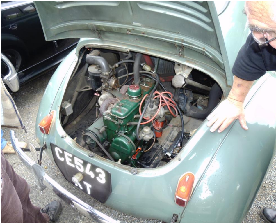
Le compartiment moteur de la 4 CV
