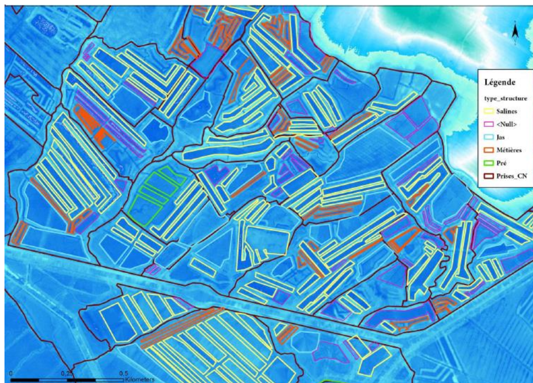
Figure 2944 : structures salines sur cadastre et lidar (prise de Saint-James à Saint-Jean-d'Angle)
