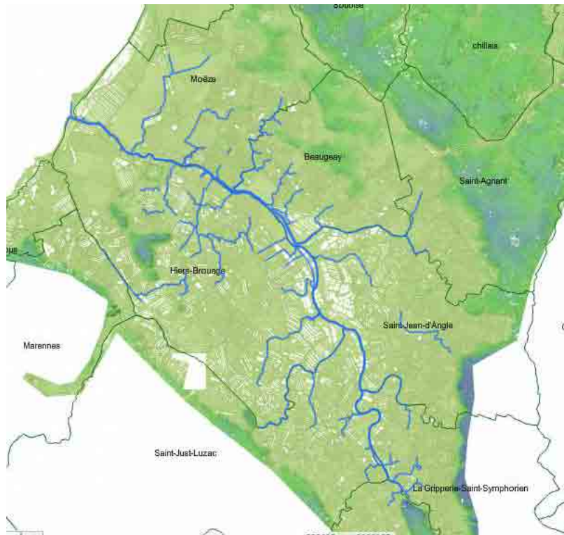
Figure 14 : Tracé (en bleu) de l'ensemble des chenaux principaux et secondaires d'après la carte de Masse superposé au fond altimétrique actuel LIDAR
