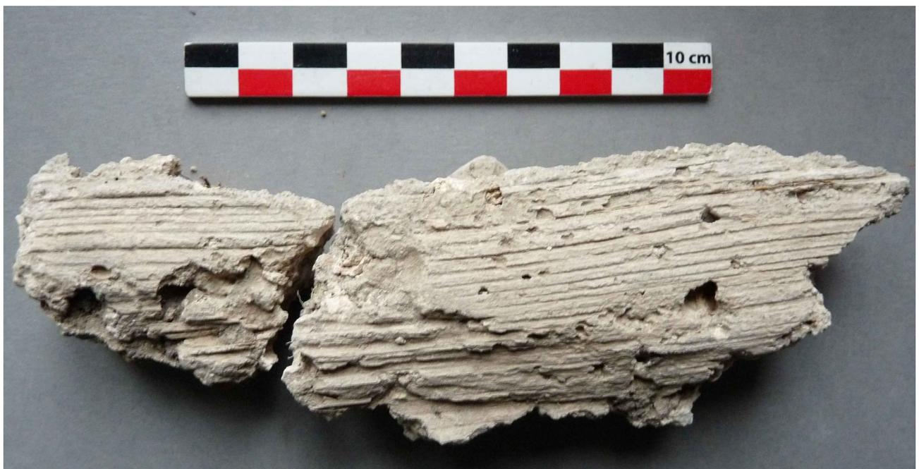
Figure 40 : Sondage 09, détail de mortier portant la trace en négatif d'une poutre (cliché B. Oury, 2017)
