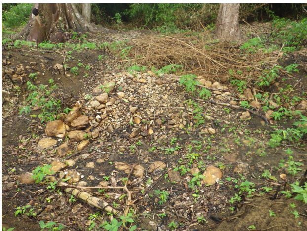
Figure 16 Matériaux de refus du crible : tas de galets lavés, crique Bon Accord
