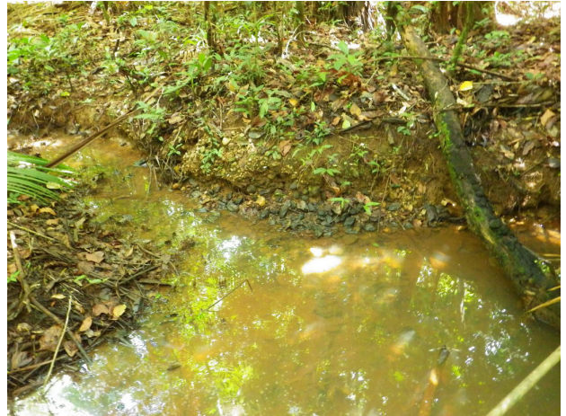
Figure 13 Canal de fuite à l'issue d'une fosse d'extraction avec affleurement de la couche de graviers minéralisés dans le talus de la fosse, crique Grand Fossé
