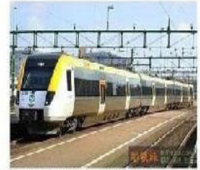
庞巴迪为瑞典 AB 提供的 Regina, 200 公里级别 (营运速度 200KM/h, 最高速度 250KM/h)
