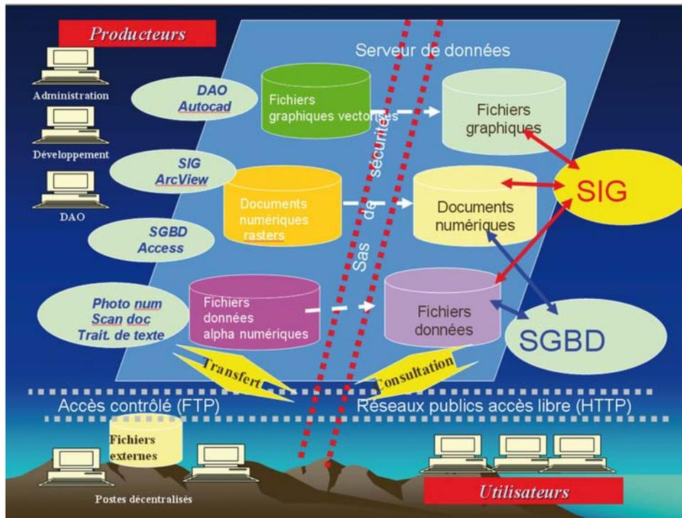
Fig. 8. Schéma fonctionnel global de GISSAR (image Dominique Pargny, 2008).
