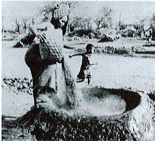
Figures 15-16-17. Transvasement de la terre concentrée : de la parcelle B dans le filtre
