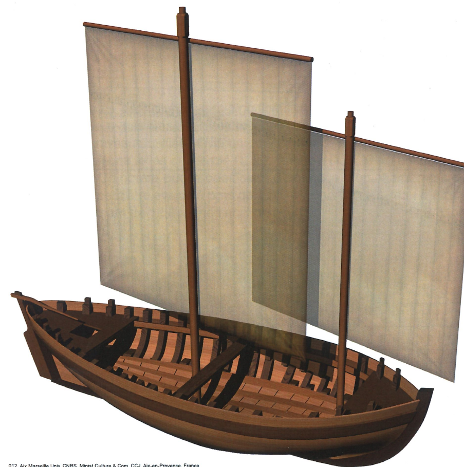
Fig. 39 : Vue du modèle 3D de restitution, avec le gréement de l'hypothèse n° 2 (P. Poveda, AMU, CNRS, CCJ).
