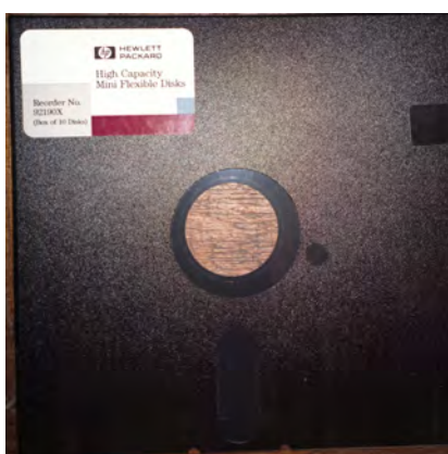
Illustration 8. Floppy disk : disquette 5.25 pouces
