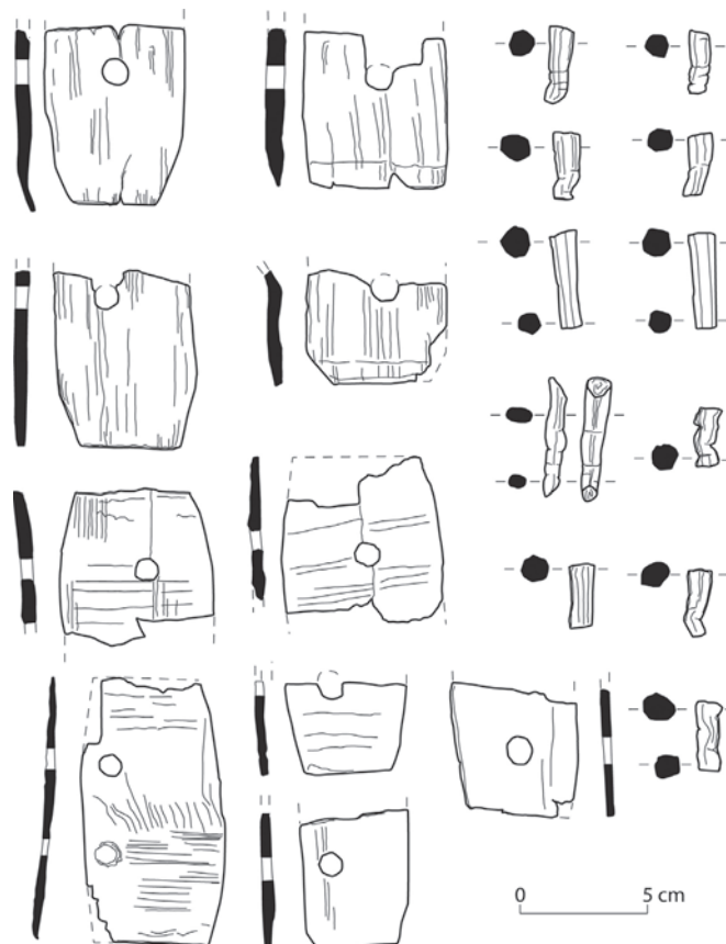
Fig. 20 : Tenons et chevilles provenant de l'épave Napoli A (dessin G. Boetto).
