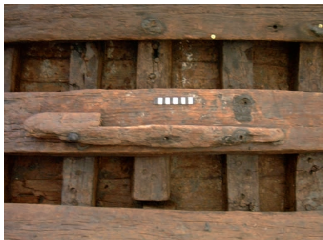
Fig. 37: Le taquet cloué sur la serre Fi2At (cliché G. Boetto).
