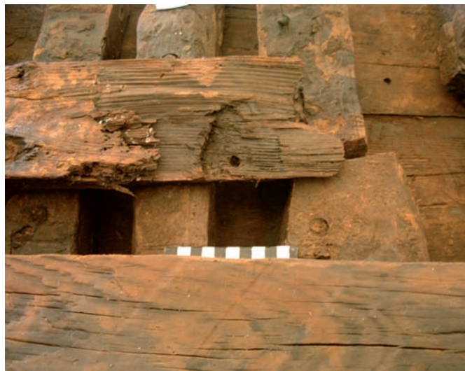
Fig. 29 : Détail de la mortaise visible sur la serre de remploi Fi3At (cliché G. Boetto).
