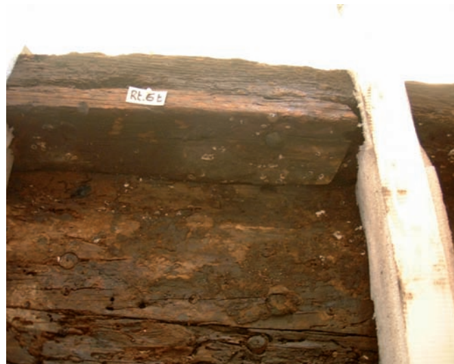
Fig. 35: Le romaillet Rt6t employé pour réparer l'angle inférieur de la préceinte T17t (cliché G. Boetto).
