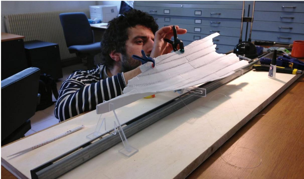
lijeva strana) i uzdužnim presjekom tj. brodskim krajevima (pramac/krma). Zaključak rekonstrukcije sugerira da je brod iz Zambratije vjerojatno bio dug 9,11 m, širok 2,28 m i visok 66 cm na presjeku glavnog rebra. Unatoč zaobljenom poprečnom presjeku, trup ima vrlo oštro i okomito formirane krajeve (pramac/krmu).
