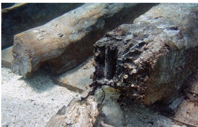
Sl. 64 Slomljen kraj rebrenice F119W s korodiranim svornjakom *in situ* (foto: Ph. Groscaux).
