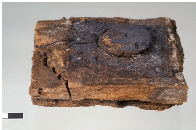
Sl. 83 Uzorkovani dio oplate s prirodnim čvorom, pod zakrpnom olovnom pločicom L24 (foto: Ph. Groscaux).
