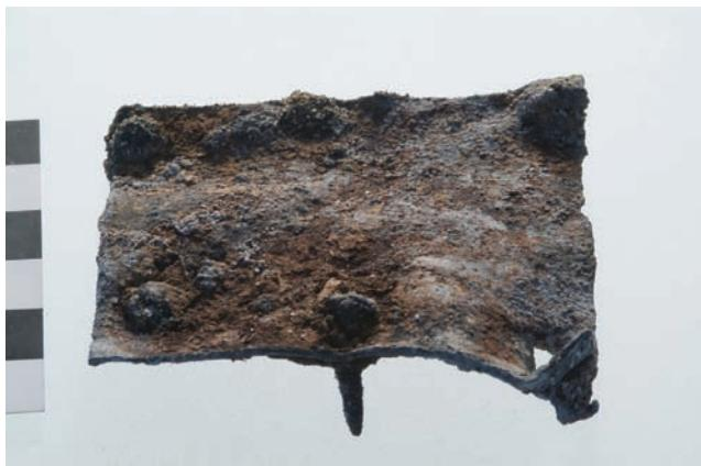
Sl. 79 Primjer zakrpne olovne pločice (PK07/03), pričvršćene malim metalnim čavlićima (foto: F. Groscaux).
