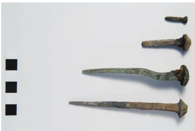
Sl. 66 Metalni čavli raznih veličina iskorišteni za gradnju i popravak broda (foto: Ph. Groscaux).
