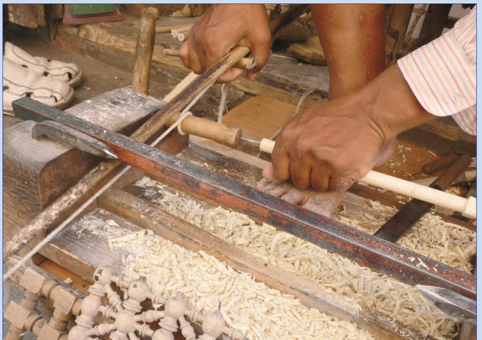
Fig. 3 — Étape avant le tournage, pointage en bout avec un petit perçoir langue de carpe. Remarquer la gâchette dans la main droite du tourneur pour tendre la corde de l'archet. Photo réalisée les années précédentes avec un autre tourneur (cliché : Ch. Picod).
