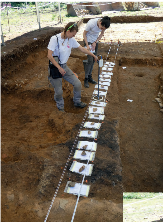
7. Bibracte, Mont-Beuvray. Un atelier métallurgique aux abords de la terrasse PC15. Mesure de la susceptibilité magnétique à l'aide d'une sonde Bartington MS2D le long d'un transect couplant mesure géophysiques et prélèvements de terre.
