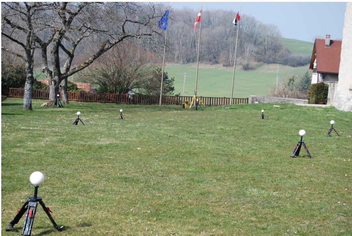
Fig. 7: Mise en place pour le relevé lasergrammétrique. Cliché: L. Benoit - SDAHS - CIHAM.
