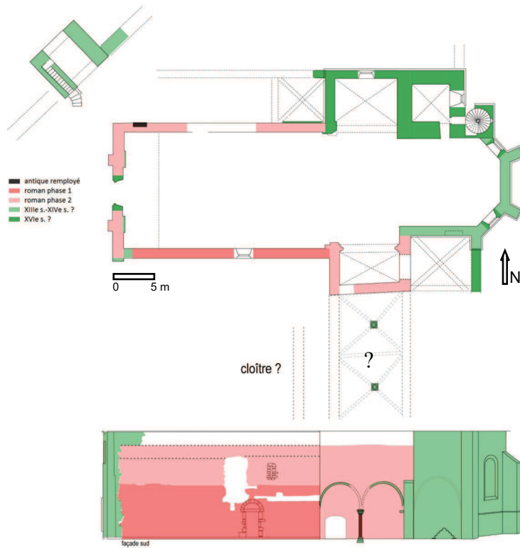
Fig. 20-21. Plan général du prieuré de Bénac, essai de restitution partielle de l'état au XIV e siècle (en haut) et au XVI e siècle (en bas) avec essai de datation des maçonneries. Plan S.A.
