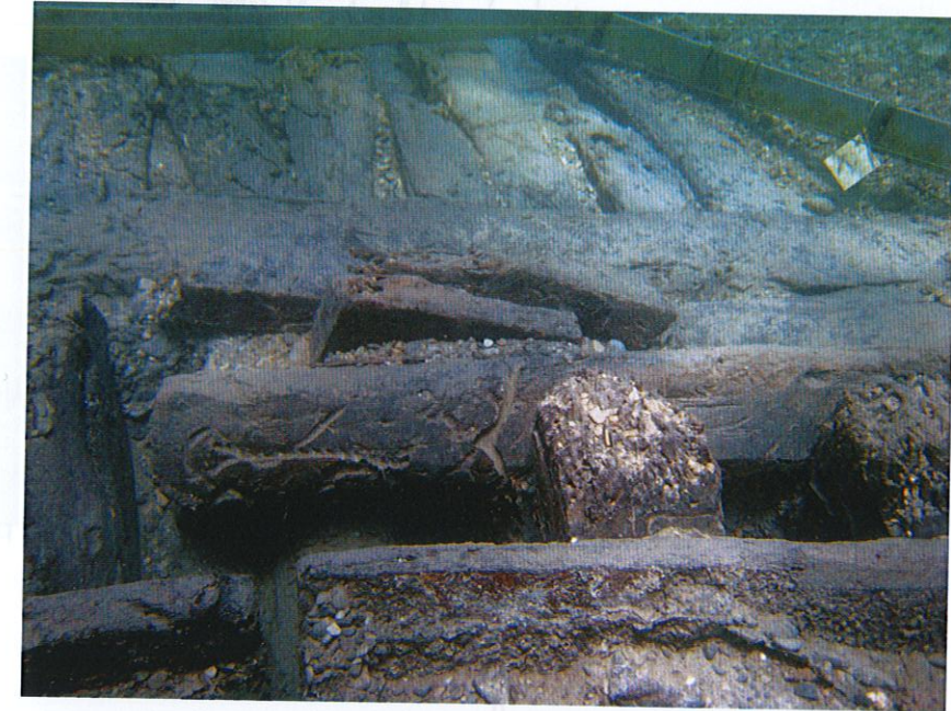
Figure 16 : Vue de côté. Carlingue encastrée sur les fourcats.
