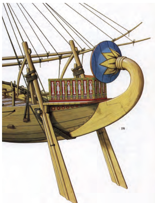
Fig. 12. L'appareil de gouverne d'un navire d'Hatchepsout (d'après Bj. Landström, Ships of the Pharaohs , Londres, 1970, p. 125 [376]).
