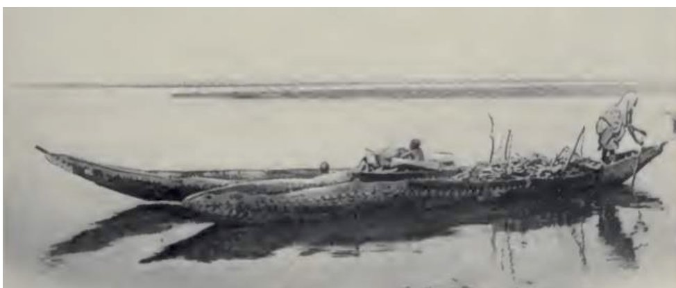
Fig. 15. Pirogues en bois cousu du Moyen-Niger en 1912 (d'après J. Meniaud, Haut-Sénégal-Niger I , Paris, 1912, pl. XII, après la p. 54).
