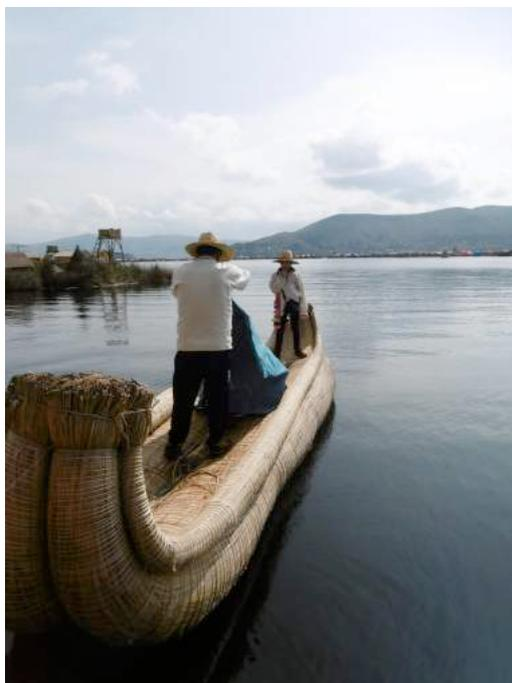
Fig. 11. Une embarcation de roseaux sur le lac Titicaca. En raison de la légèreté du matériau utilisé, l'essentiel de l'embarcation, même dotée d'un creux, se trouve au-dessus de la ligne de flottaison (d'après <http://www.levoyageducyclope.fr/2018/03/le-lac-titicaca-arequipa.html>).
