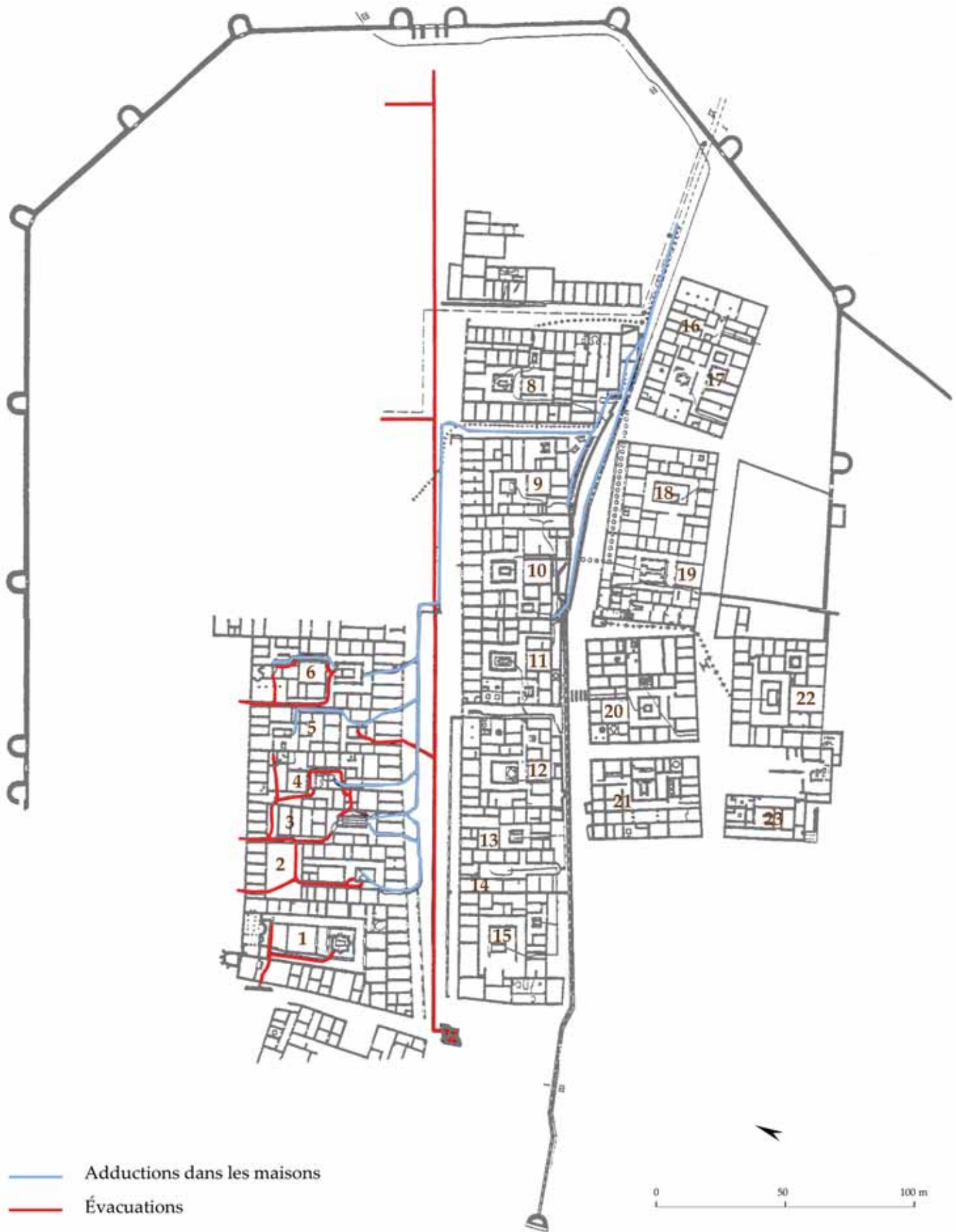
Pl. 6 – Volubilis. Plan du réseau hydraulique (Étienne 1960, vol. 2, plan hors texte).
