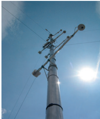
Mât équipé d'un anémomètre sonique
