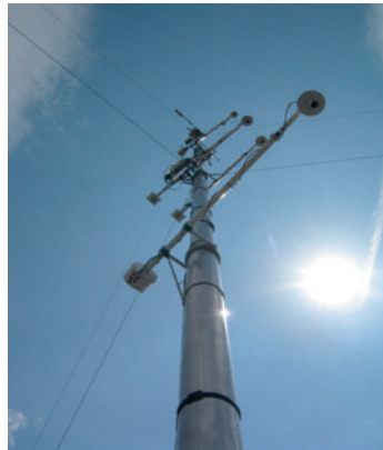
Mât équipé d'un anémomètre sonique
