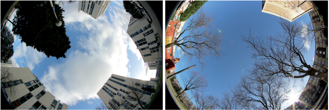
Figure 3. Photos du type fisheye issues de la campagne de mesure effectuée dans le projet ANR-Eurequa pour estimer le facteur de vue du ciel depuis le sol sur un site avec un facteur de vue du ciel relativement bas (à gauche) dû à la présence de bâtiments relativement hauts ainsi que d'un arbre et sur un site avec un facteur de vue du ciel haut (à droite).
