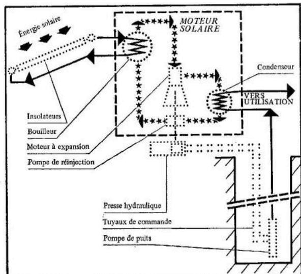
L'installation comprend deux circuits autonomes fermés, l'un d'eau et l'autre de gaz. Ces deux éléments sont mis au contact l'un avec l'autre, à un certain moment, mais ils ne se dépensent jamais. Il n'est jamais nécessaire de rajouter de l'eau : elle circule en circuit fermé. Il n'y a jamais besoin de rajouter du fluide : il est également en circuit fermé.
