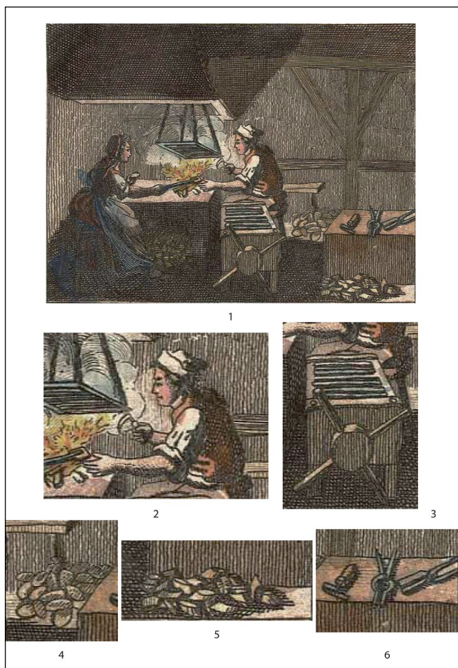
Fig. 20 – Ambrosius Gabler, Der Hornpresser , (1 : gravure complète, 2 : cornetier muni d'une serpette, 3 : presse à vis, 4 : étuis cornés aplatis, 5 : déchets, 6 : outils employés), fin XVIII e siècle, Allemagne. Musée d'Art Populaire, Dresde (musée d'Art Populaire, Dresde).
