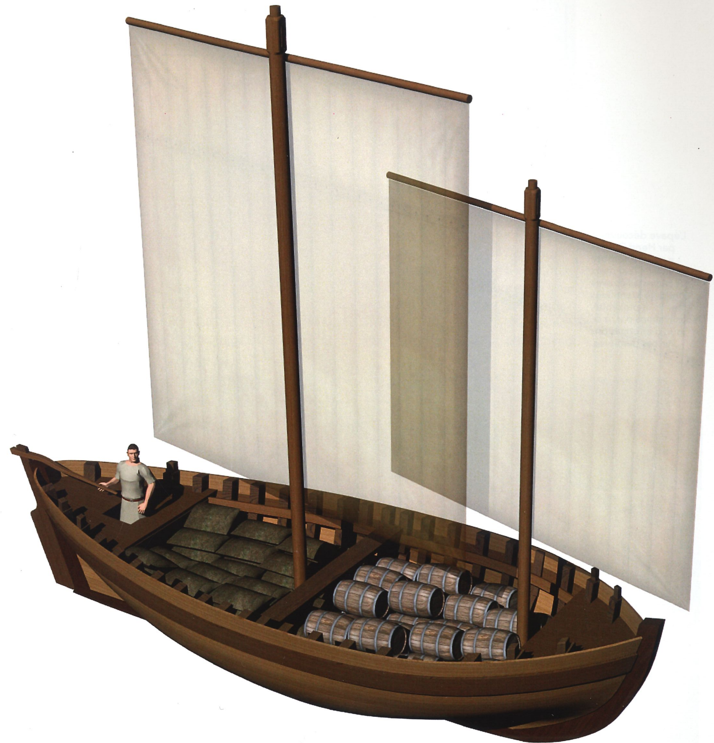
Restitution complète du caboteur d'Erquy et de son chargement. PIERRE POVEDA, AMU, CNRS, CCJ.
