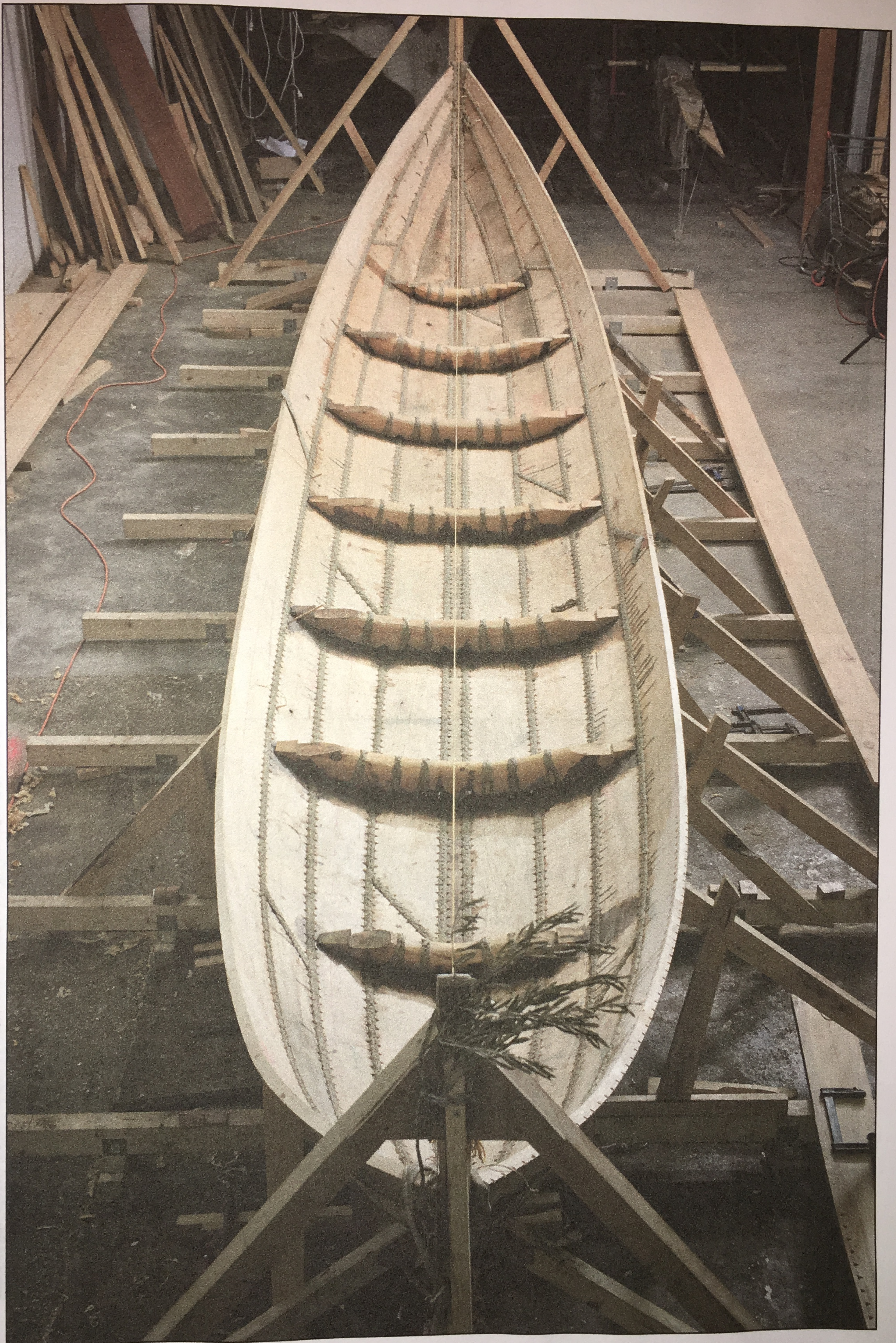
Fig. 4. Vue du montage du *bordé et des *varangues de fond du Gyptis.
