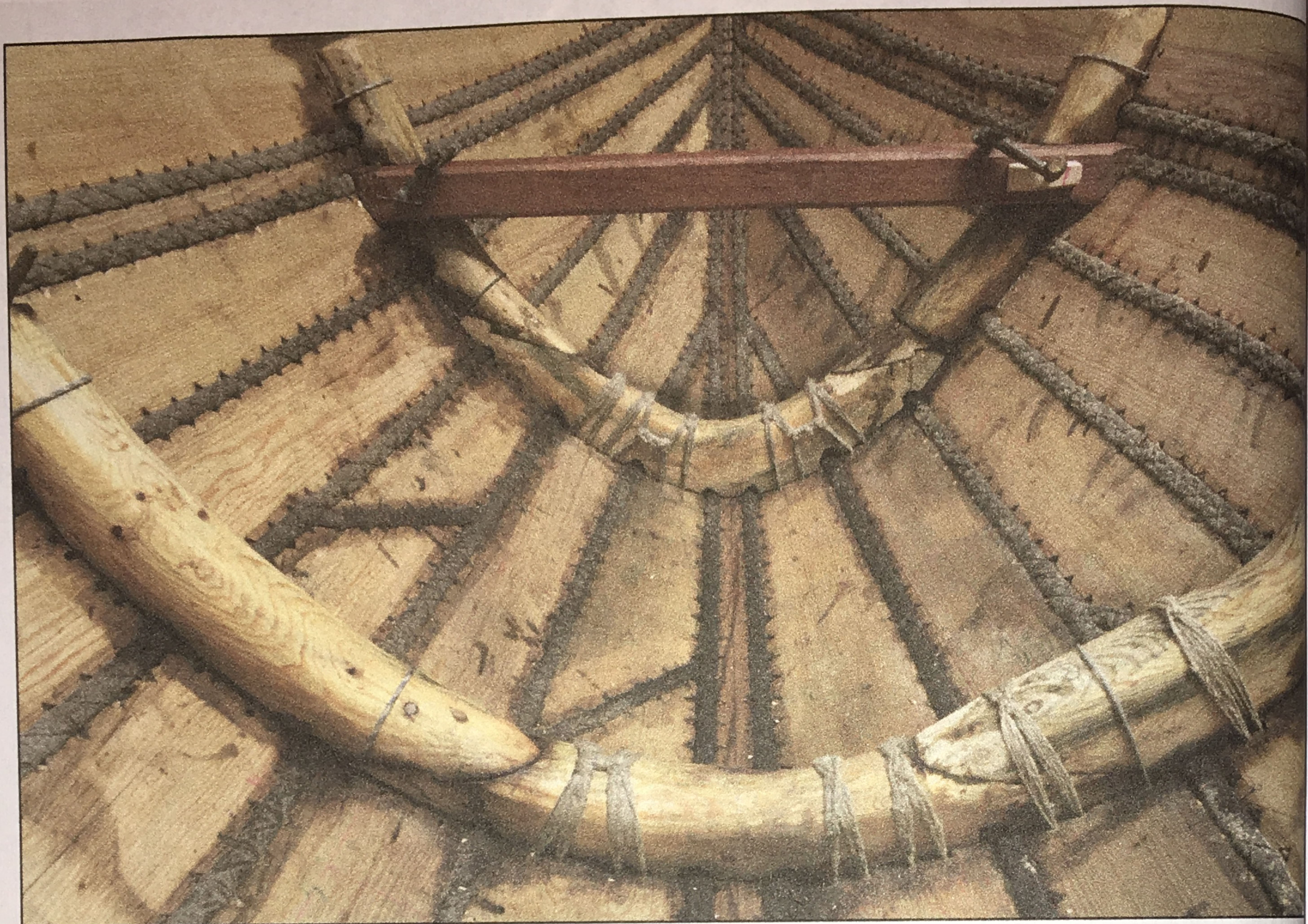
Fig. 5. Vue de détail de l'assemblage par couture du *bordé et par ligatures de la membrure du Gyptis .
