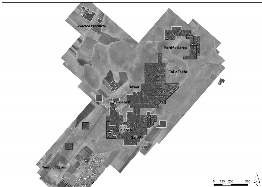
تصویر ۱- نقشه مغناطیسی بررسی های انجام شده در محوطه پاسارگاد بین سال های ۱۳۷۸ تا ۱۳۹۵. دیاگرام مگنتوگرام بین (۲-/+۲ نانوتسلا بر متر) از سفید تا سیاه. Figure 1- Overview of the results of the magnetic survey carried out over Pasargadae and its surroundings since 1999 until 2016. The magnetogram dynamics is -2/+2 nT/m from white to black.
