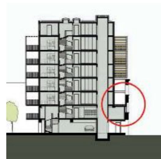
Fig. 5- Coupe du Quai Ouest sur la rue de la faïencerie montrant le décalage entre les balcons et les percements de la façade conservée (© P. Hernandez)
