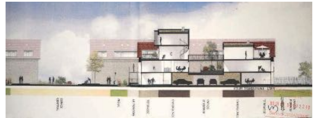
Fig. 7- Coupe transversale de Village Bacalan : les anciens chais, très profonds, s'ouvrent pour créer des espaces de desserte intérieure plantés. Au-delà du grand jardin central, les pleins alternent avec les vides. Le parking est en rez-de-chaussée, caché au cœur du bâtiment (© PC 08 Z0224, ville de Bordeaux, Leclercq & Associés)
