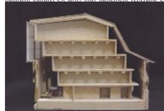
Fig. 15- Maquette en coupe montrant les magasins superposés et la salle de lecture (© Livret de présentation des Archives municipales de Bordeaux, Robbrecht et Daem)
