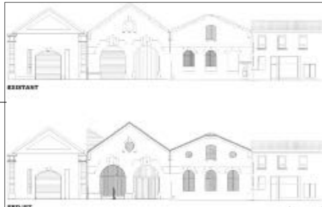
Fig. 7- Façade avant/après cours Édouard-Vaillant (© PC CANAL, Atelier d'architecture, 2015)
