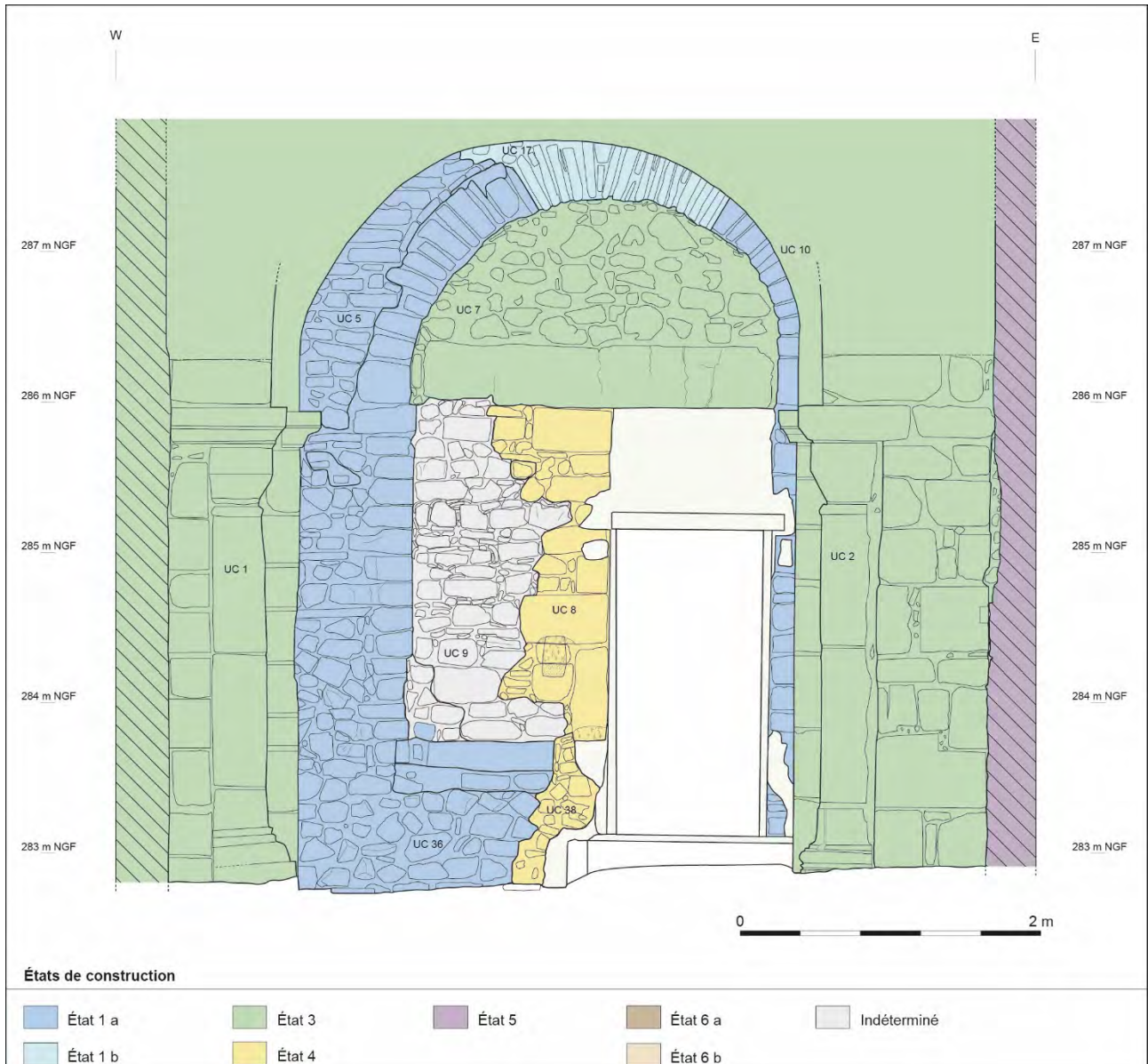
Fig. 2. Savigny (69) : chapelle Saint-Léger : mur nord, parement nord. Phasage de la construction (1/40). C. Besse, A. Devillechaise, L. Eneau-Brun, O. Puel, B. Solard.
