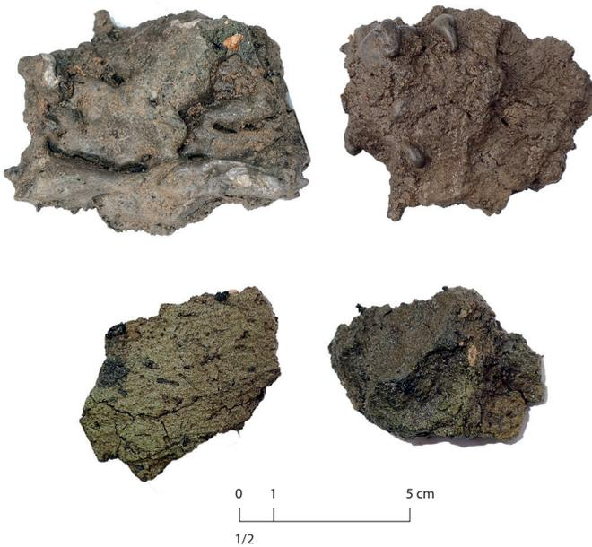
Fig. 13. Scorie et morceau de sole de four trouvés dans l'US 1112. © ZBM.
