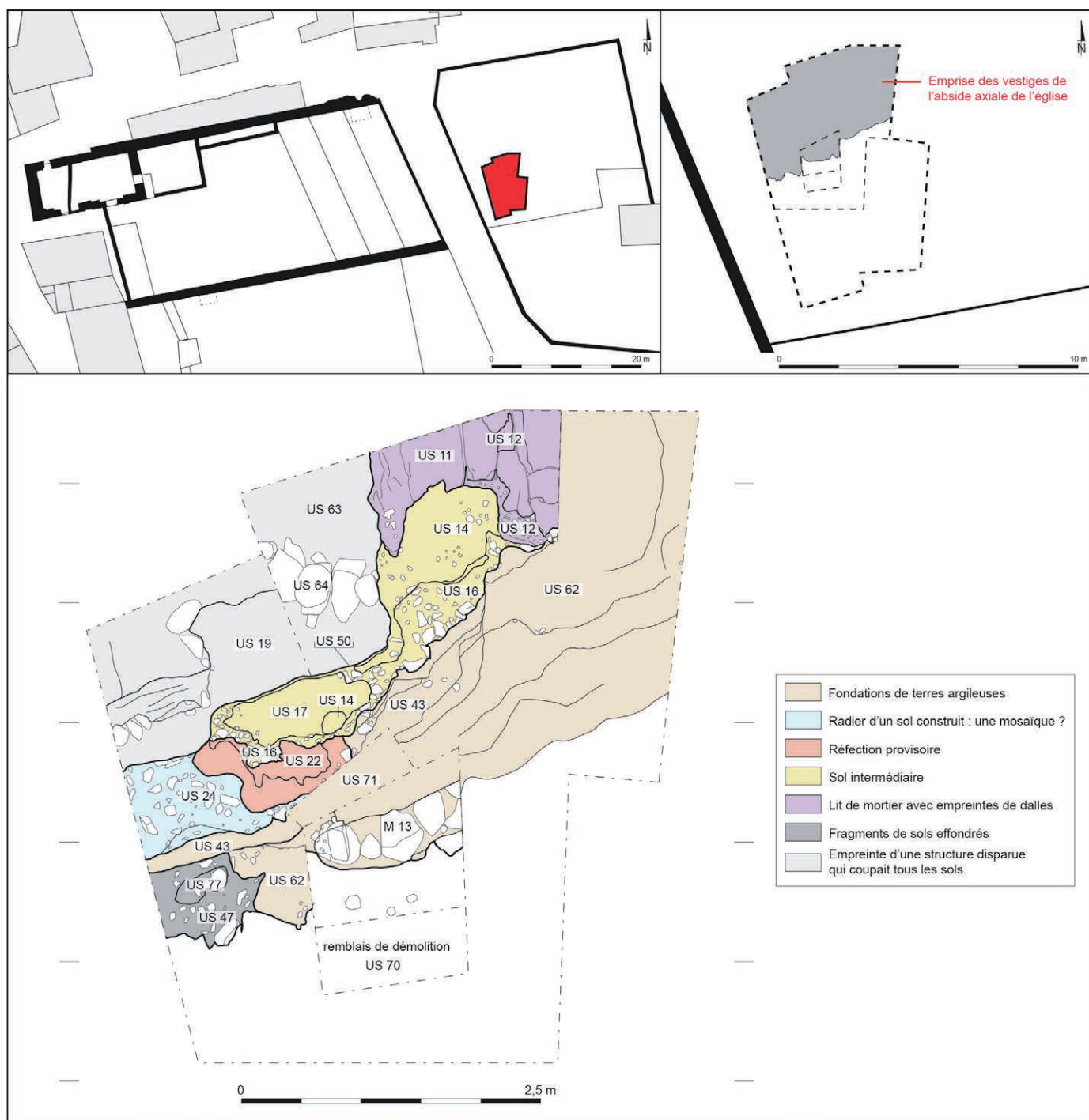
Fig. 33 Emprise du chevet, sondage d'évaluation : plan archéologique des niveaux de fondation et de circulation (1/50) (relevé Baptiste Quost et Olivia Puel; DAO Aurélie Devillechaise, Olivia Puel et Charlotte Ybard, 2018).
