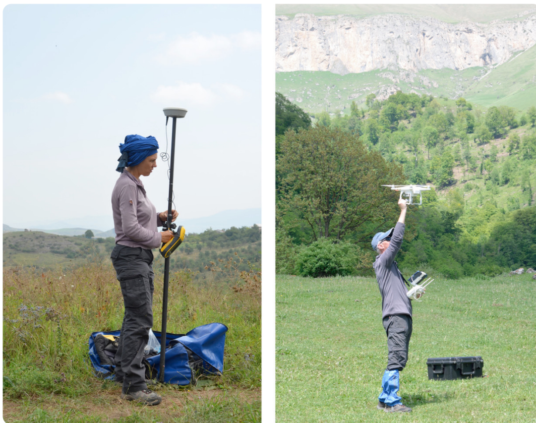
Fig. 5 : E. Régagnon en train d'utiliser le GPS différentiel pour localiser les points qui serviront à recadrer les photographies prises au drone par A. Mkrtychyan (© B. Perello – T.A.P.)
