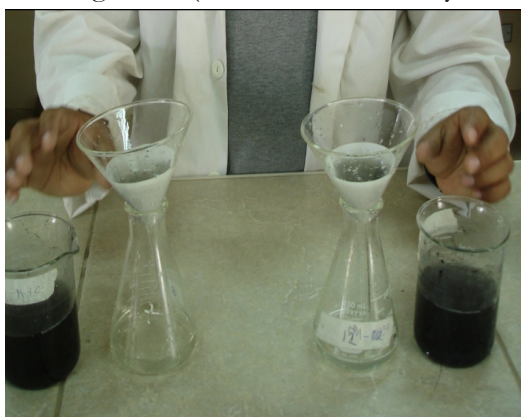
Fig. 6: Muestras Filtradas con Coagulante y Floculante(poliacrilamida) y Floculante.
