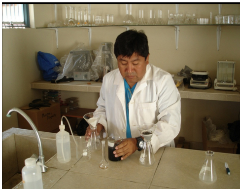
Fig. 1: Preparando las Muestras para el Ph Inicial.
