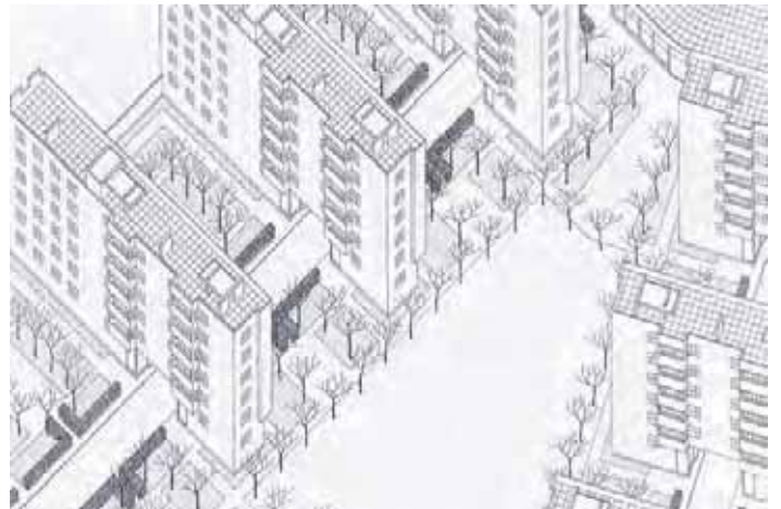
Logements sociaux à Villeneuve-Saint-Georges, Projet présenté aux CIAM de Francfort en 1929 - La disposition des bâtiments répond à une logique héliotropique tandis que des bâtiments bas assurent la liaison entre eux et referment l'îlot.
