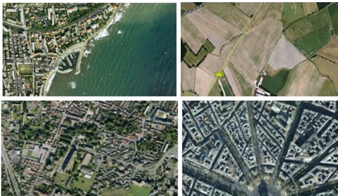
Figure 6.01 : Classe de rugosité aérodynamique : 0, II, IIIa, IIIb, IV (lecture à partir du haut à gauche, sens horaire)
