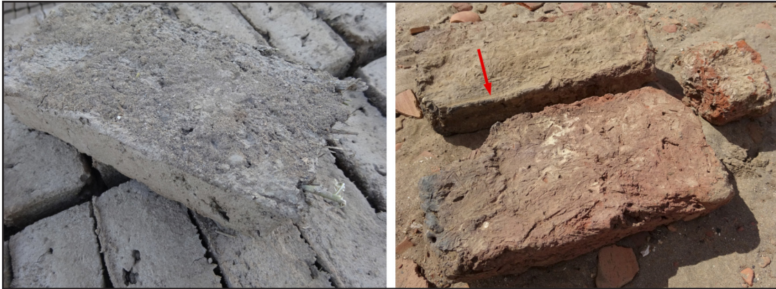
Figure 7. Terre et éléments végétaux ayant adhéré à la face de la brique en contact avec le sol lors du séchage (à gauche) ; bourrelet indiquant un moulage dit « au ballon » ou « au coup d'eau » et traces de raclage sur une brique antique (à droite)
