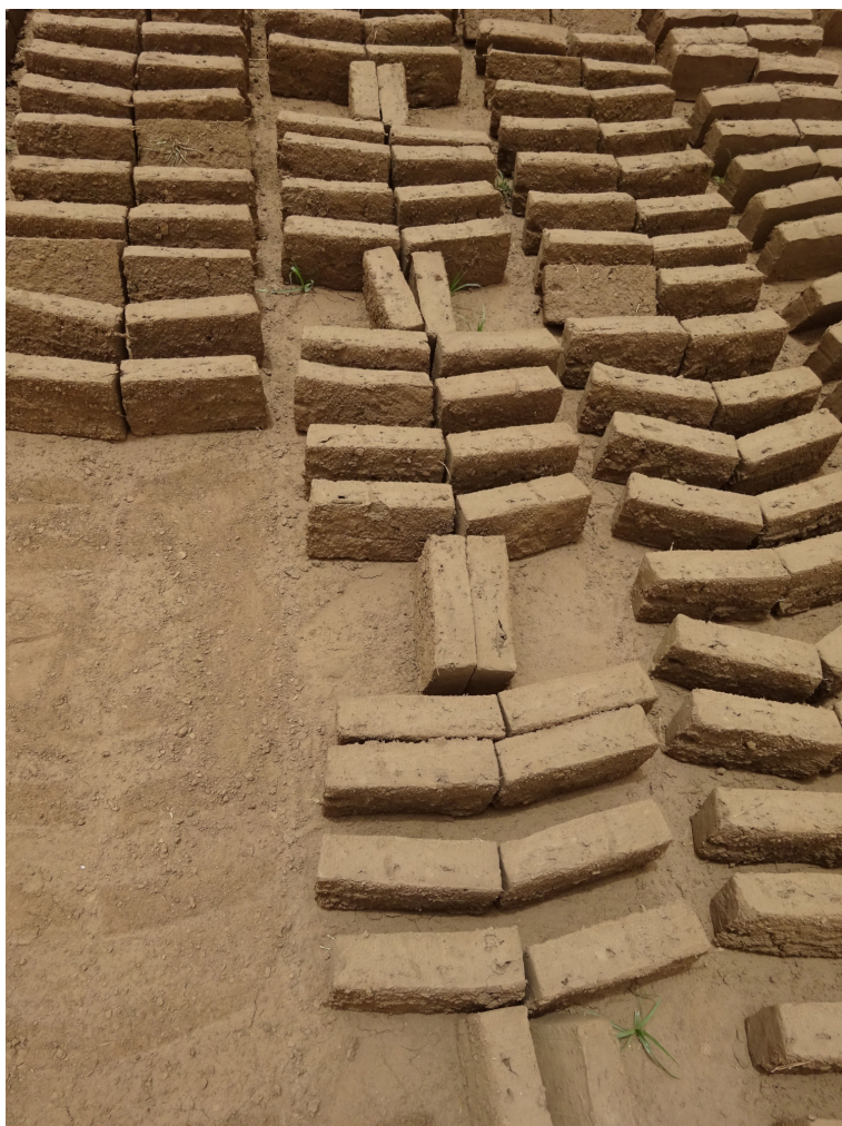
Figure 5. Briques en cours de séchage posées sur la tranche 5 juillet 2018, île de Tuti, Khartoum.
