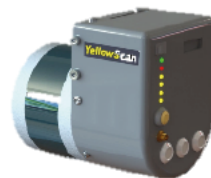
Capteur SURVEYOR YellowScan • 3 à 5 cm de précision ; fréquence laser 300 kHz ; 300 000 impacts/s ; balayage scanner 360° ; 80 m de porté
