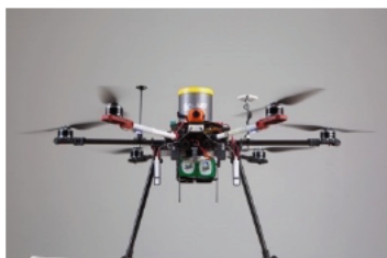
Drone DPS6 Big Lift (homologué S1,S2,S3) • technologie DJI A3, Lightbridge 2 • autorisé DGAC (S3) ; autonomie 10 20mn
