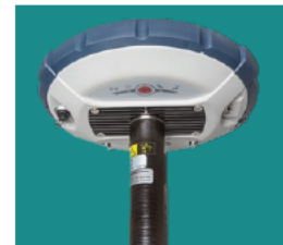
Antenne GNSS • base fixe ; rayon 5 km, 3H, spectra SP60
