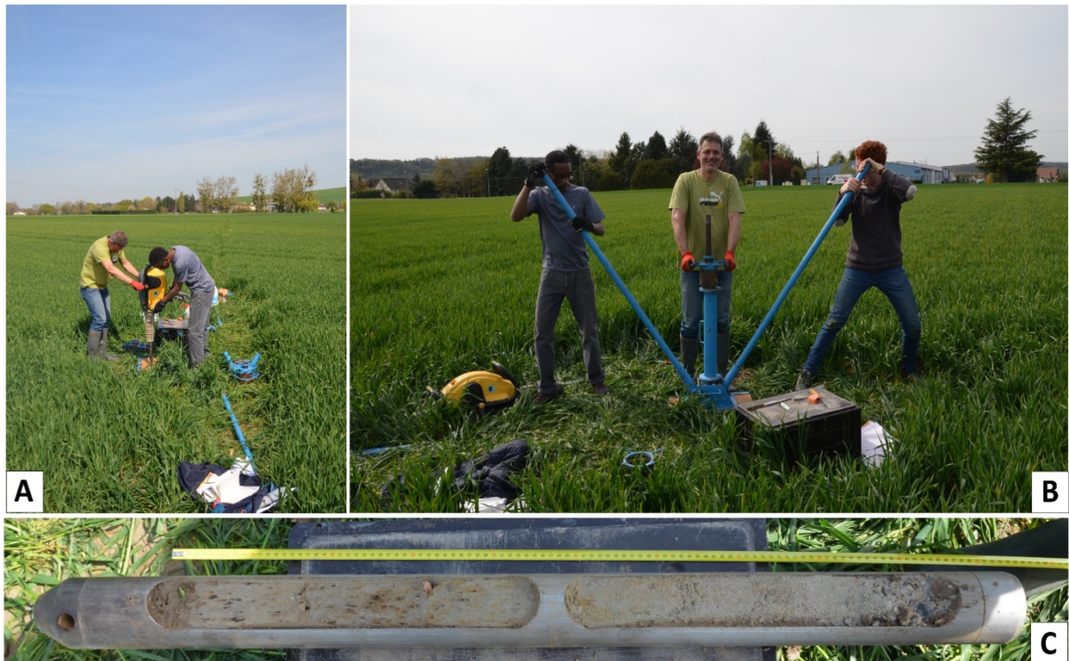
Fig. 3 Carottage à l'aide d'un carrotier à percussion cobra MK1 du laboratoire PRODIG (A) ; extraction de la gouge (B) ; analyses texturale et structurale de la carotte sur le terrain et sélection des prélèvements pour les analyses en laboratoire (C) [Photos Fr. Bétard et Th. Piau, 2019]
