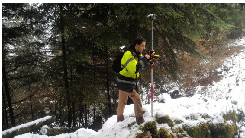
Fig. 44 : GPS GeoHX en cours d'utilisation
