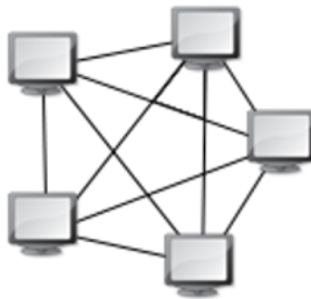
Figure 2 : Topologie de réseau maillé. Source : Wikipedia, https://fr.wikipedia.org/wiki/Topologie_de_r%C3%A9seau
