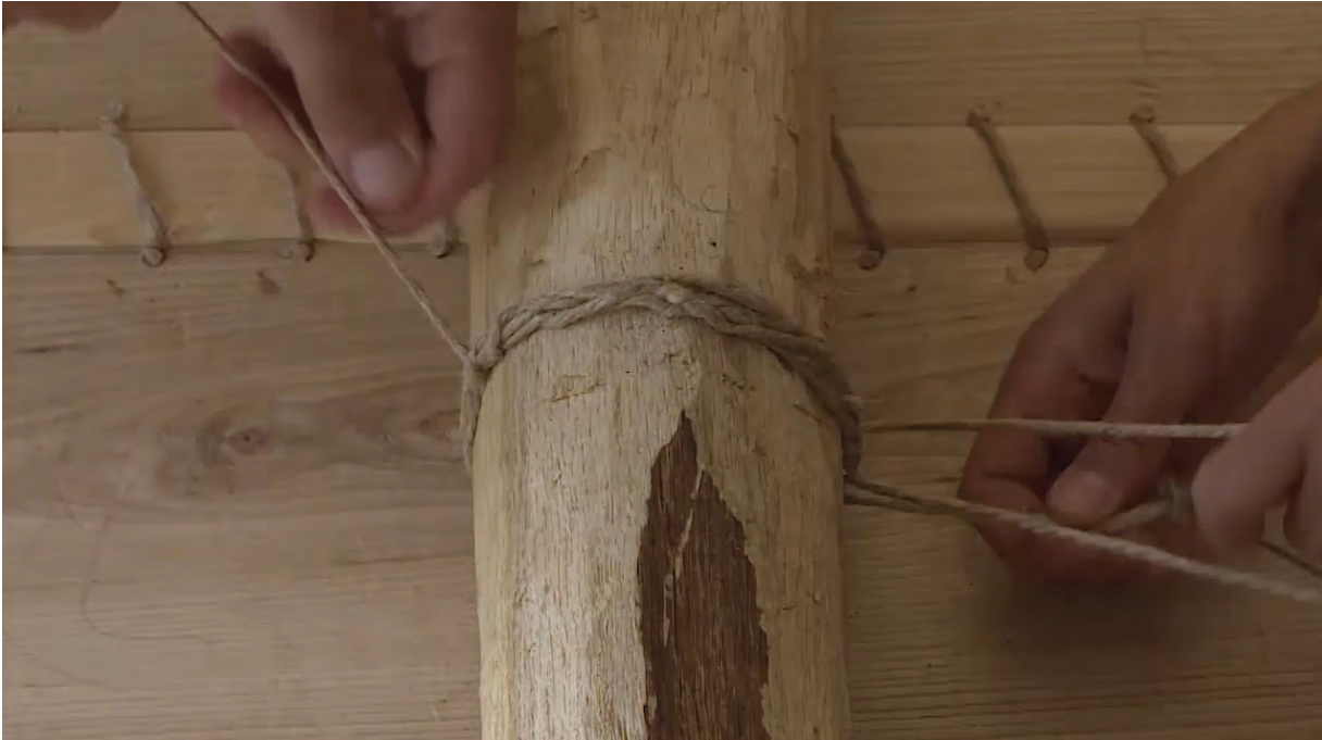
II.68 Vezivanje rebra za oplatu Lashing the frame to the planking (fotografija / photo by: M. Račan)
