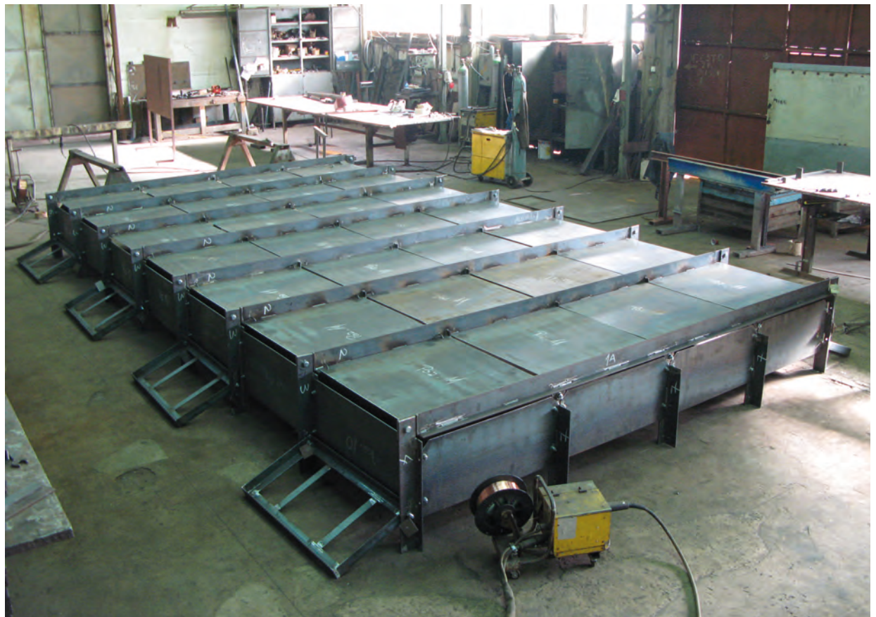
I.39 Zaštitna metalna kutija u izradi Protective metal box being made (fotografija / photo by: M. Uhač)
