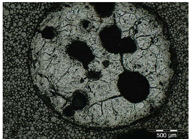
Fig. 5 : Métallographie d'une battiture globulaire : fayalite en lattes ( \text{Fe}_2\text{SiO}_4 ) © Guillaume Saint-Didier.
