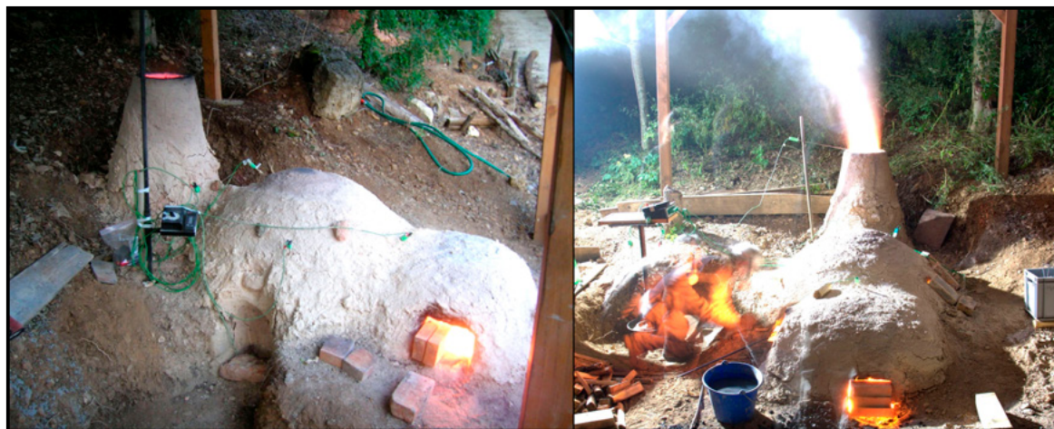
Figura 10. Fotografía del horno de reverbero experimental en funcionamiento. El mismo es un modelo a escala del horno de reducción registrado en Vila Punku Cueva.
