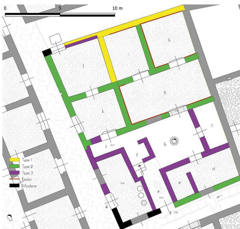
Fig. 24. Les trois types d'appareil observés dans les élévations de la Maison IV A.
